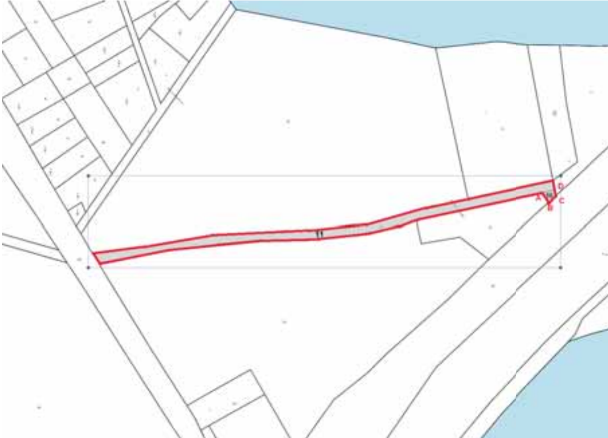
Auszug der Karte aus ARCHIKART, Lage der Straße mit rot gekennzeichnet, die Teilfläche des Flurstücks 10 mit ABCD
