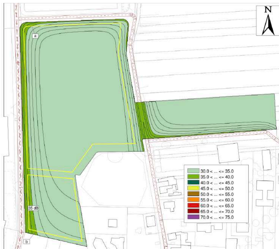
Abb. 5: Rasterlärnkarte, erforderliche Bau-Schalldämm-Maße R'_{w,ges} (S. 21 im Gutachten)
