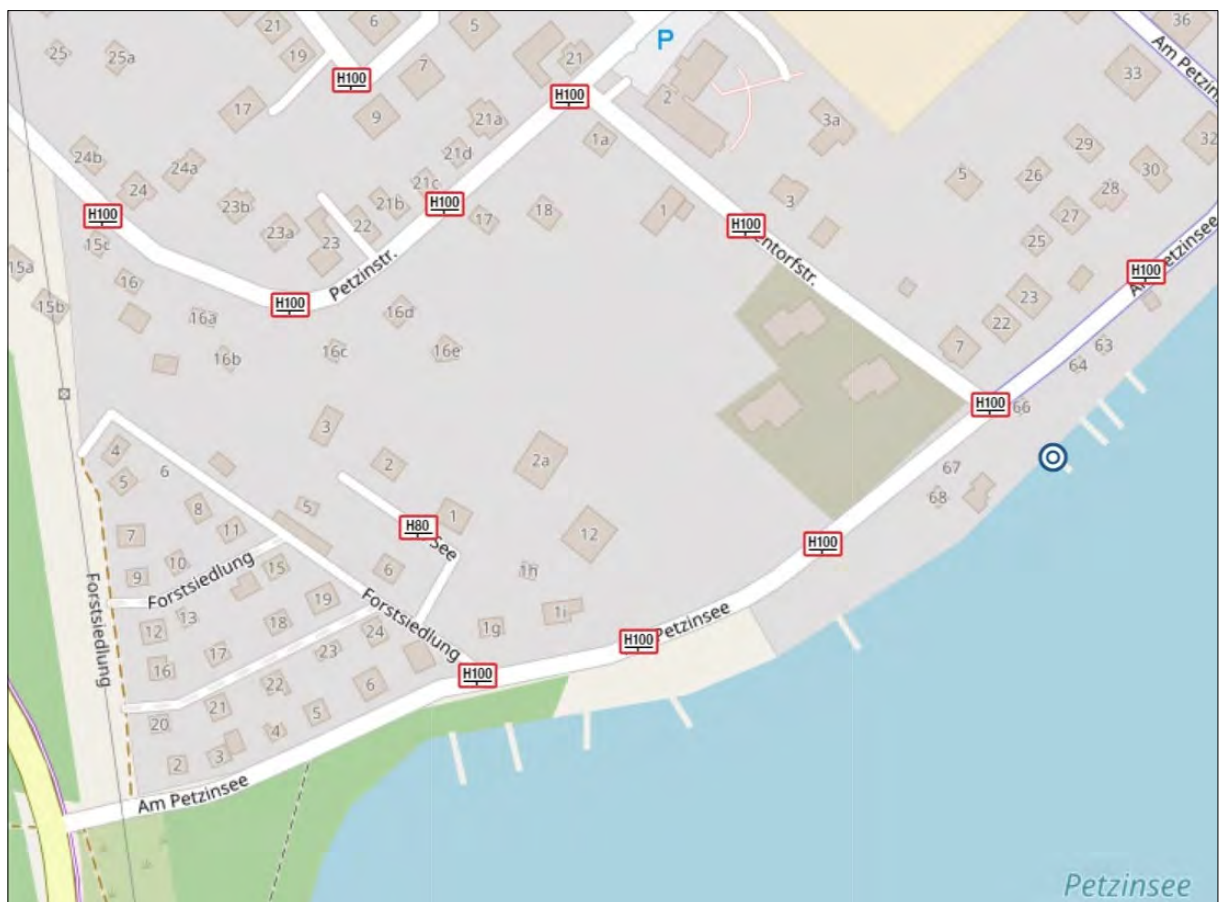
Abb. 14 Löschwasserversorgung / Hydranten im Umfeld des räumlichen Geltungsbereichs des Bebauungsplans "Wohnen am Petzinsee"
