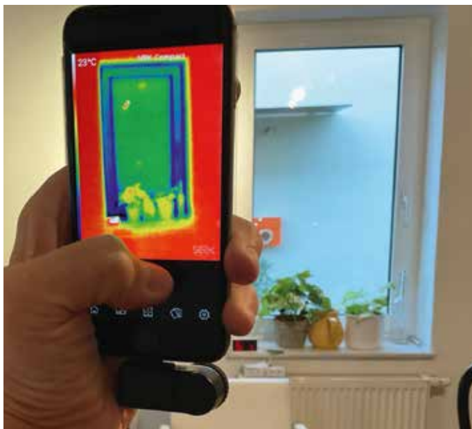
Klappt hervorragend: Wärmelecks identifizieren mit einem Wärmebild-Aufsatz fürs Handy Foto: Wilhelm Neikes
