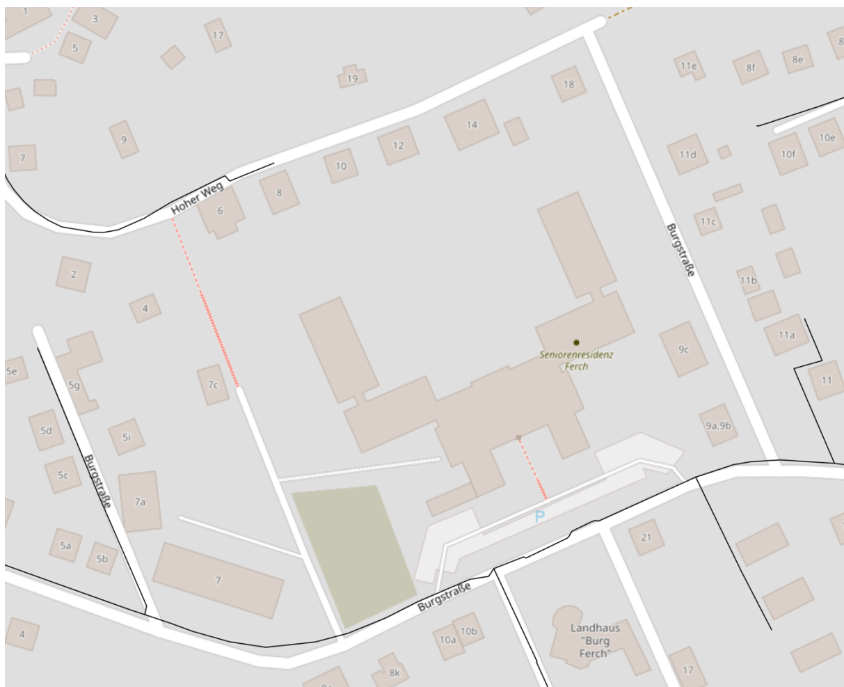
Abbildung 2: Im Plangebiet verlaufende Gasleitungen (schwarze Linie) 2
